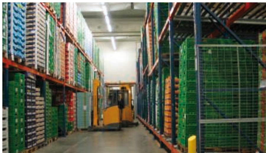
Bild 1 Während die Vorratspaletten nach wie vor in konventionellen Regalen lagern (links), erfolgt die Bereitstellung für die Kommissionierung komplett via Fließlagertechnik (rechts).
