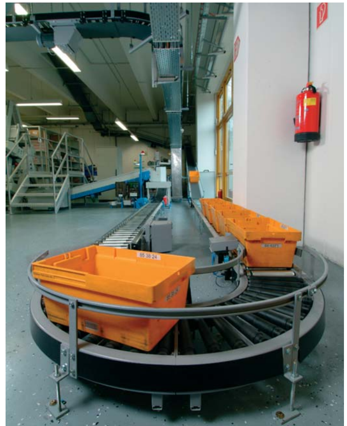
Die Transportbehälter werden mit einer Fördergeschwindigkeit von 0,5 m/s, örtlich auch höher, bewegt.
