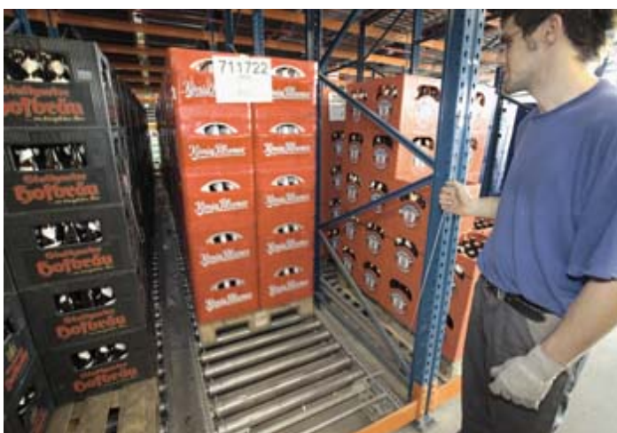
Bild 04 Nach der Leerpalettenentnahme wird die Vollgutpalette durch Handseilzug automatisch nachgefördert (Entriegelungsautomatik).
