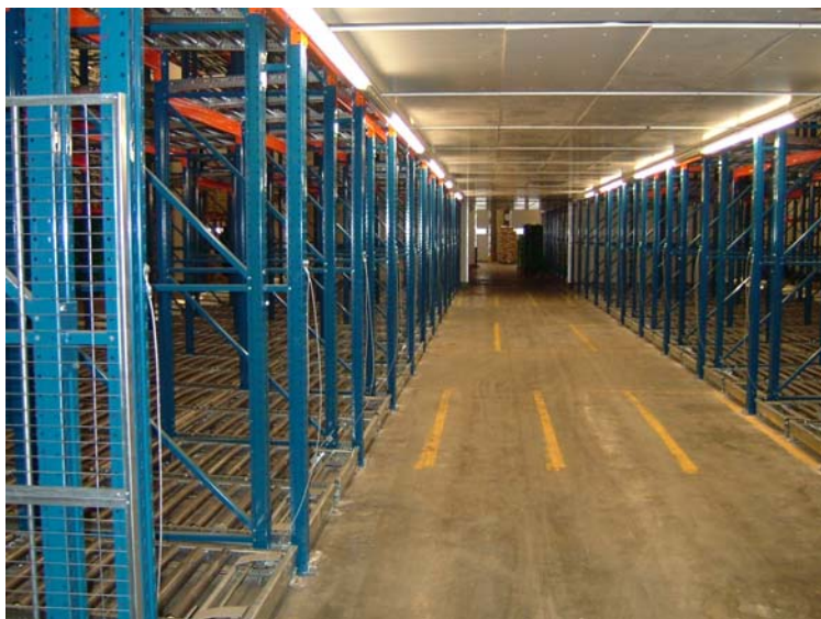
Bild 05 Blick in den Kommissioniertunnel: Bereitstellung auf Wheel Flow- Rollenbahnen von Interroll für sicheren Palettenquertransport.
