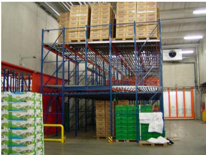
Bild 03 Einschubregalanlage zur Pufferung von Übermengen sowie Bereitstellung von Versandartikeln. Unter den beiden Ebenen können Paletten oder Rollcontainer bereitgestellt werden.
