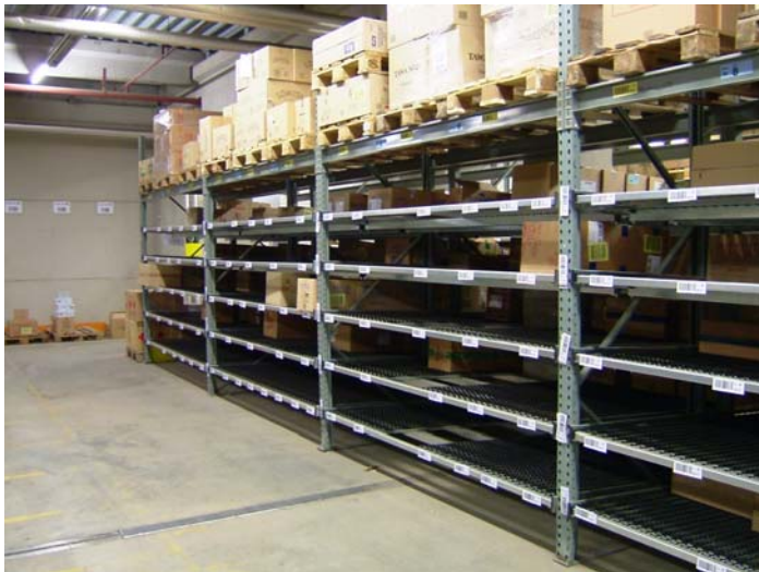
Bild 02 Durchlaufebenen mit Röllchenleisten von Interroll. Diese sind bei dieser Anwendung in vorhandene Regalstatik eingeschraubt.
