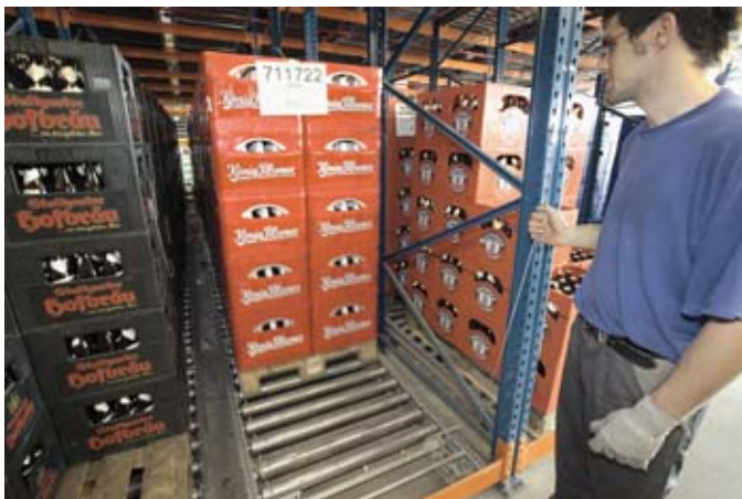
Bild 37 Nach der Leerpalettenentnahme wird die Vollgutpalette durch Handseilzug automatisch nachgefördert.
