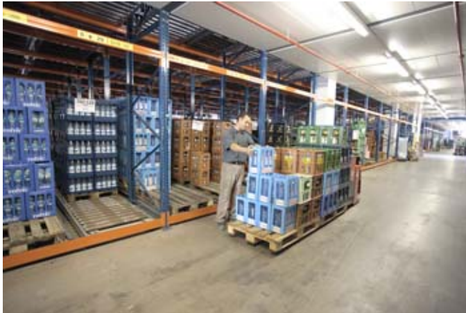
Bild 36 Eine hohe Kommissionierleistung gewährleistet die permanente Warenpräsenz auf der Entnahmeseite der Durchlaufbahnen.
